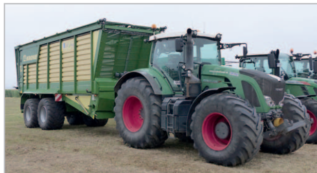
Návěs pro dopravu objemných hmot s podlahovým dopravníkem Foto autor
