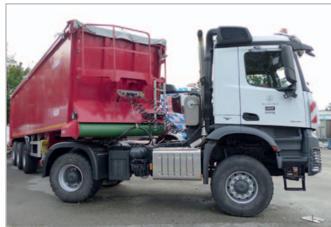
Pro tzv. agrotahače jsou určeny mj. návěsy s podlahovým pásovým dopravníkem Foto autor
